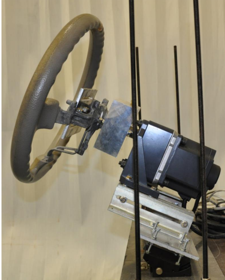
図 2-6 ステアリングホイールに接続された操舵反力トルクモータ 自由使用可能な [2-3] の Fig. 4 より転載
