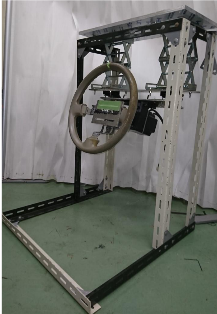
図 2-7 ステアリングホイールの高さ調節機構 自由使用可能な [2-3] の Fig. 5 より転載
