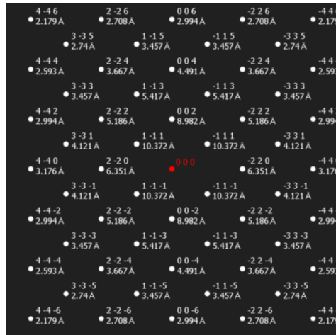
図 2-11 Cu-16 mass%Sn-0.3 mass%Ti ブロンズ（加工率 94.3 %）を 400 °C で焼鈍した後の析出物の透過型電子線回折パターン。谷口博康，菊池章弘：低温工学，Vol. 47 No.8, pp. 526-533, 2012. 4) より引用し改変。
