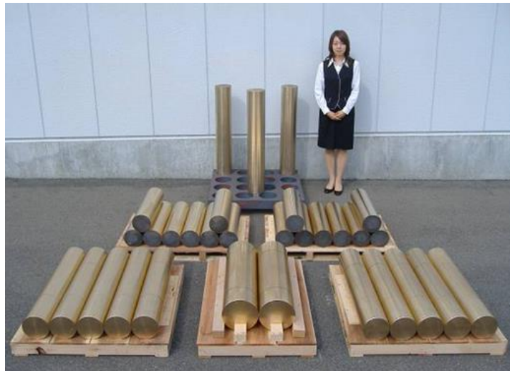
図 1-18 水冷一方向凝固法による超電導用ブロンズインゴットの写真。谷口博康, 菊池章弘: 低温工学, Vol. 47 No.8, pp. 526-533, 2012. 47) より引用。
