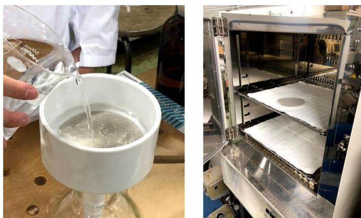
図 3.4 PM<sub>2.5</sub> の水処理および乾燥の様子
