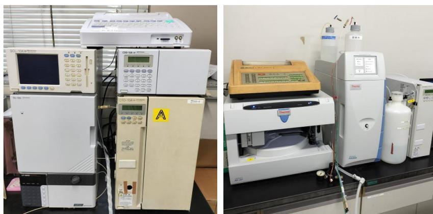
図 3.7 イオンクロマトグラフ装置 (左:陽イオン用、右:陰イオン用)
