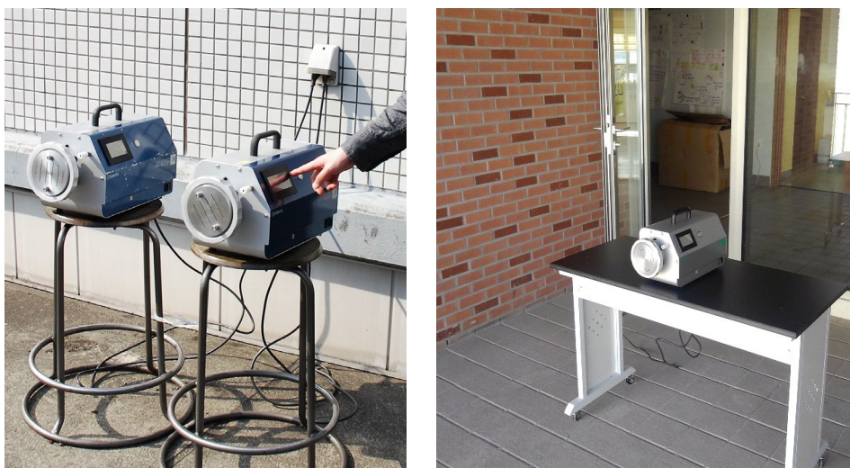
図 3.3 ハイボリュームエアサンプラーによる PM 2.5 の捕集 (左：平塚市、右：ソウル市)
