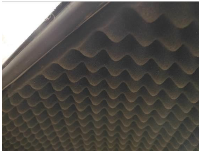
図 1-2 車内の天井部に設置した吸音材による車内騒音対策
