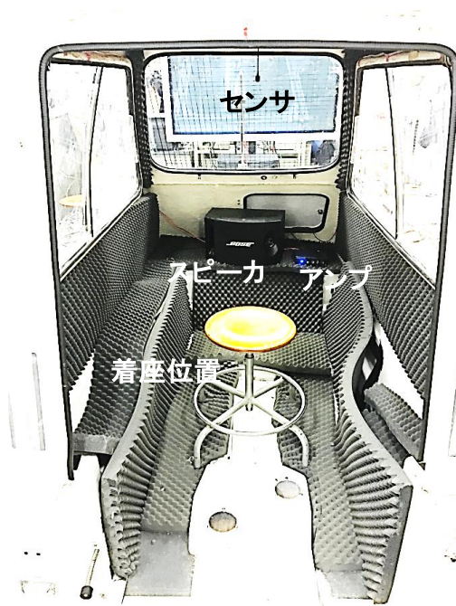
図 4-7 小型モビリティの車内に設置したスピーカと実験協力者の位置関係
