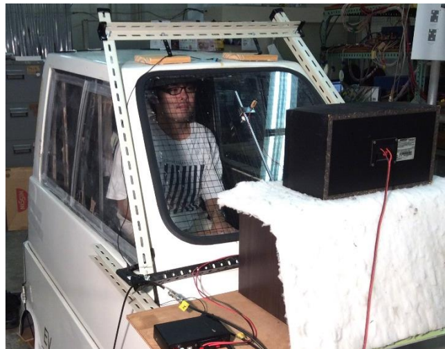
図 4-4 脳波計を装着した状態で車内に着座した実験協力者 [4-1]
