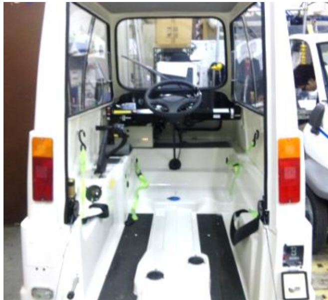
図 1-3 車内騒音対策がされていない小型モビリティの車内の様子
