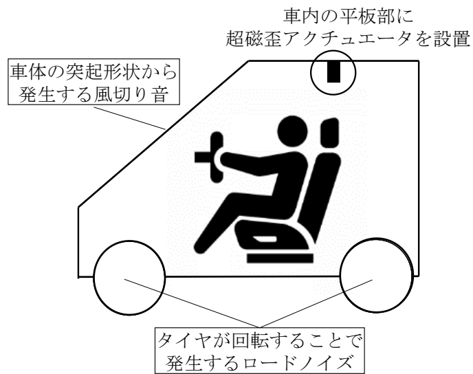
図 1-4 超磁歪アクチュエータを搭載したアクティブノイズコントロールシステム
