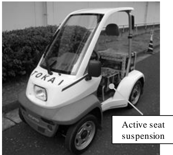
図 2-2 実験車両とした超小型モビリティ (トヨタ車体制株式会社. COMS) [2-1]
