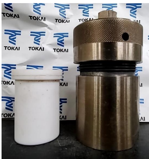
Fig.1.1.3.1 オートクレーブ(左:テフロン製容器、右:ステンレス製容器)
