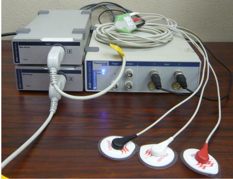
図 3-2 表面筋電位の測定に用いた機器 右：AD Instruments 社製 PowerLab 2/26 ML826 左：AD Instruments 社製 BioAmp ML132
