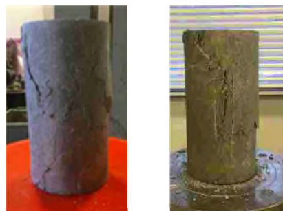
(a) 圧送前 (b) 圧送後 写真 3.9 破壊状況 ( 2\text{FCM}60\text{-L}:\text{S}_m\text{-}7:3 )
