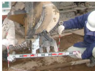
写真 2.12 機械式掘削ヘッド
