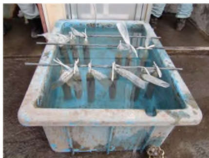
写真 1.2 セメントミルク供試体
