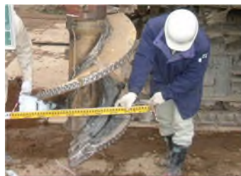
写真 2.12 機械式掘削ヘッド
