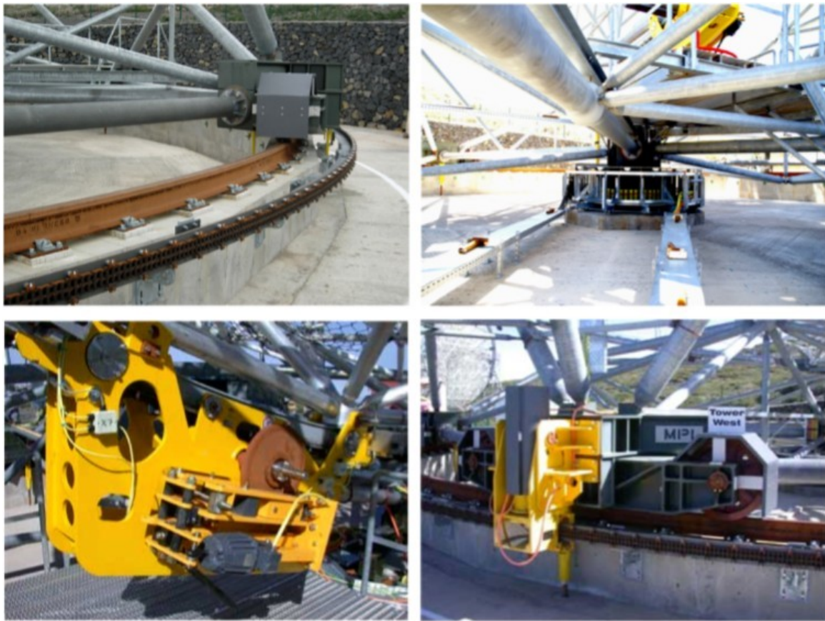
図 4.7 MAGIC 望遠鏡駆動システム
