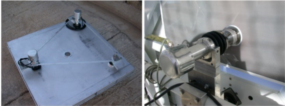
図 4.10 分割鏡裏面のアクチュエータ [167]。
