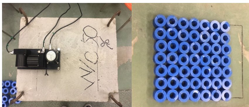
図 6-4 供試体計測状況と圧縮ばね配置状況
