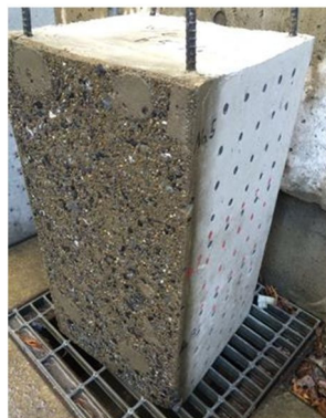
図 3-3 表層部を劣化させた角柱供試体の概観
