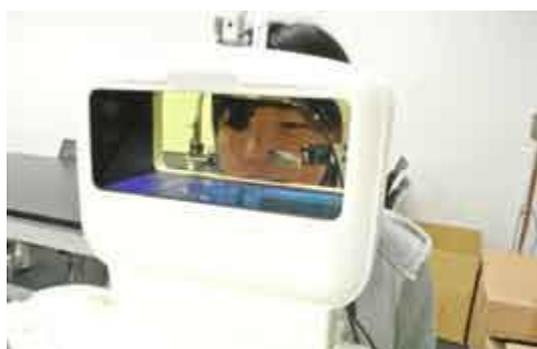
図 3-2 : 眼球運動と調節応答の同時測定機器
