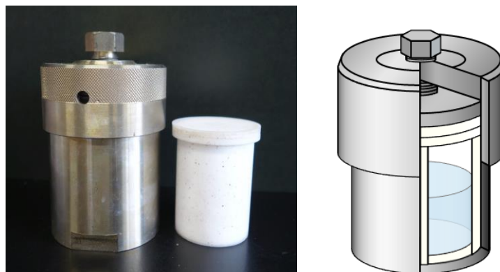
Fig. 4-2 水熱合成用オートクレーブと模式図 (写真左) ステンレス製外容器、(写真右) テフロン製内容器
