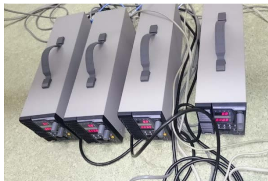
並列接続した直流電源
