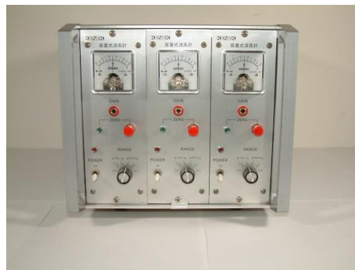
写真 4-3 波高計アンプ
