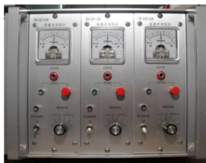
写真 5-36 波高計アンプ
