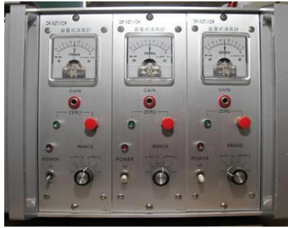
写真 5-11 波高計アンプ
