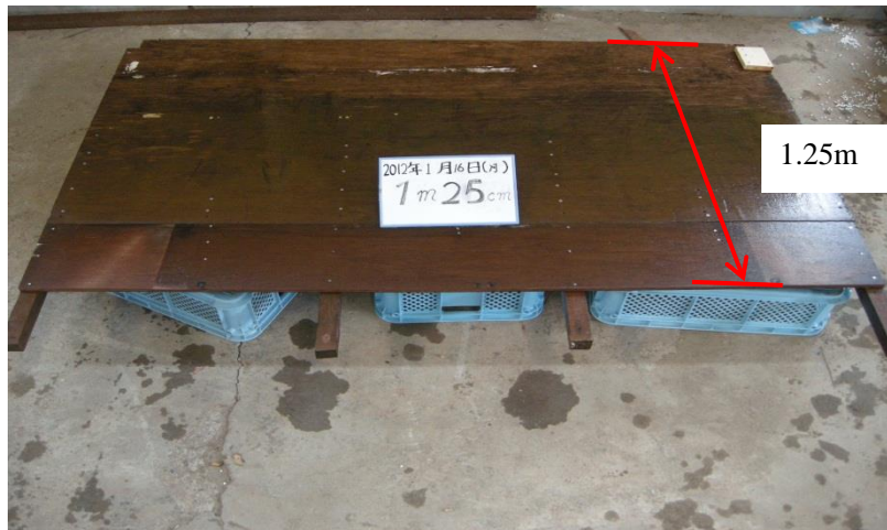
写真 5-8 傾斜板 (横幅 2m, 縦幅 1.25m)
