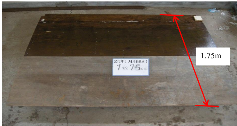
(4) 容量式波高計 写真 5-10 傾斜板 (横幅 2m, 縦幅 1.75m)
