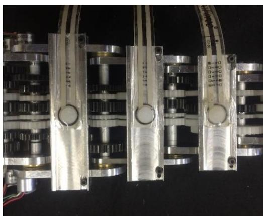
(c) 接触板への圧力センサの取り付け
