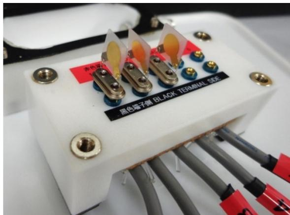
図 3.3.1-3 (a)プローブおよびガスセルと(b)水晶振動子を取り付けたガスセル
