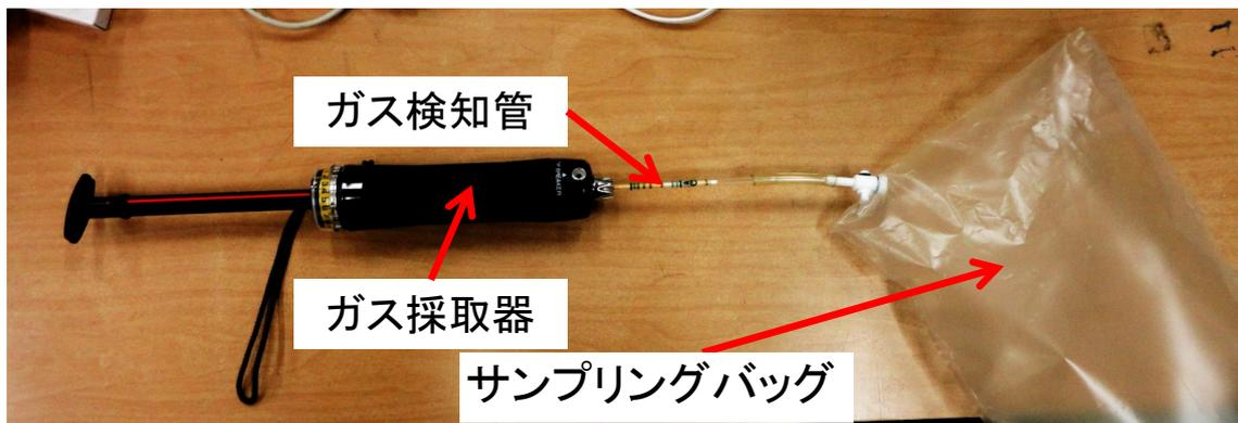
図 3.2.1-5 ガス濃度測定方法
