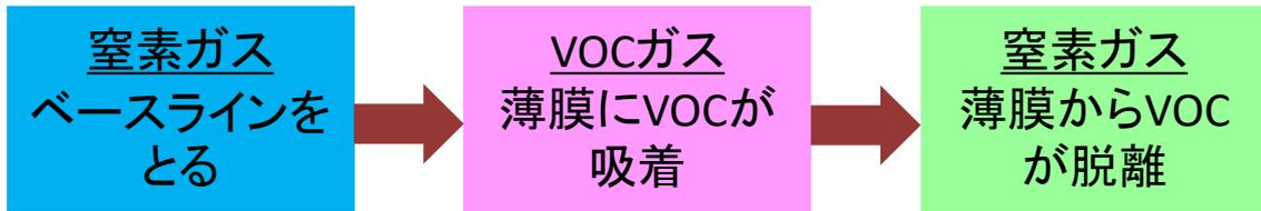
図 3.2.1-4 ガス吸着特性評価手順
