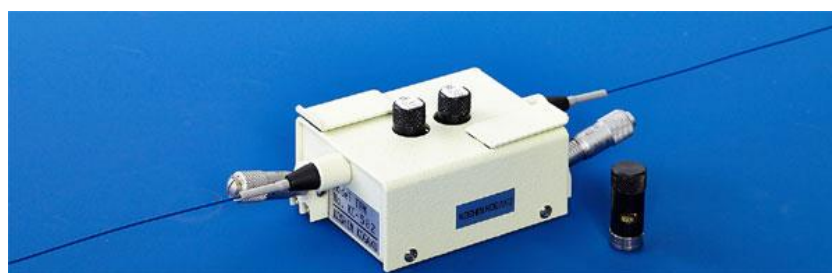
図 5-7 BPF カセットと可変モジュール(光伸光学 HP より)
