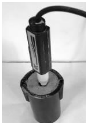
写真 3.2 比抵抗計測状況
