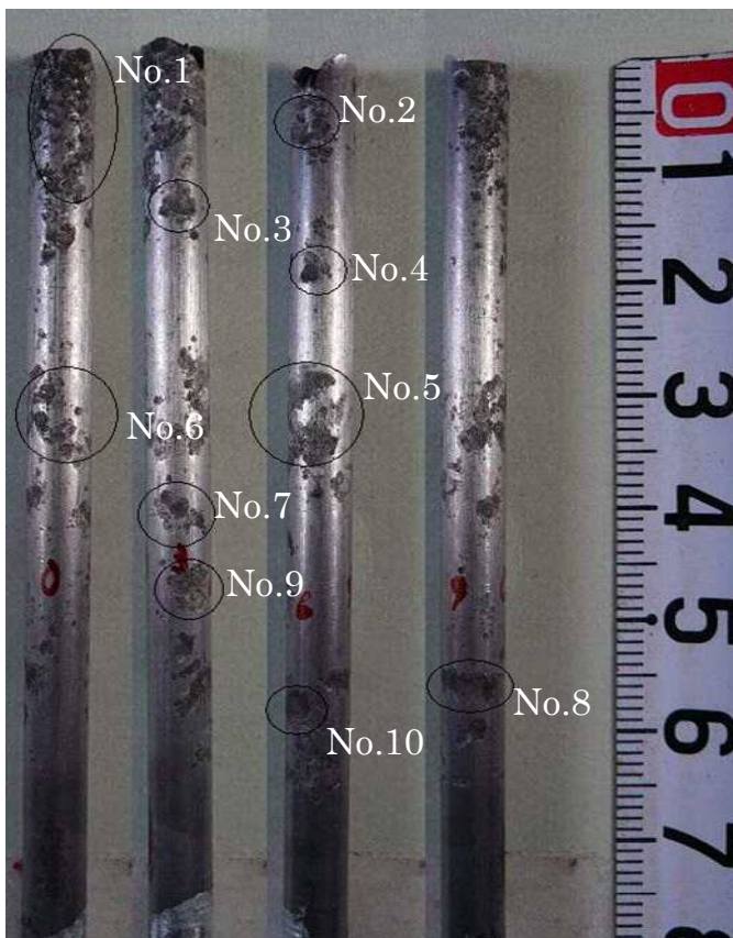
写真-3.3.3 腐食ピット例
