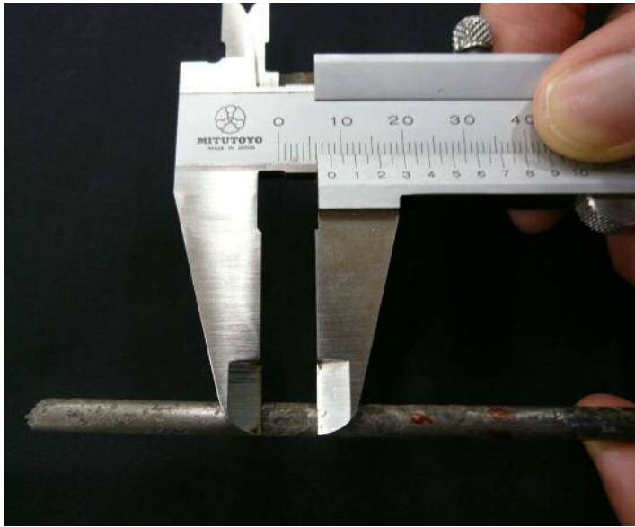
写真-3.3.2 腐食ピットの計測状況（幅、長さ）
