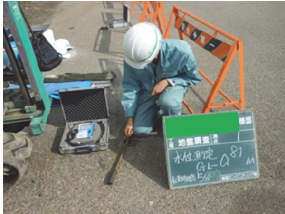
写真 3.2.2 SWS 試験直後の手動での地下水位測定状況
