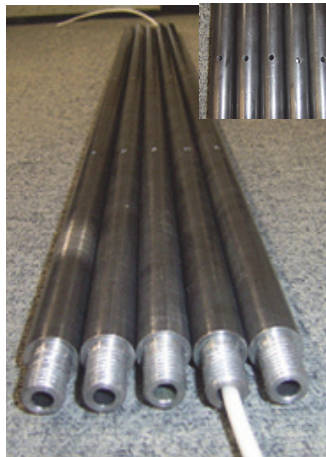
写真 3.2.3 有孔管外径 \phi 19mm (内径 \phi 7mm)
