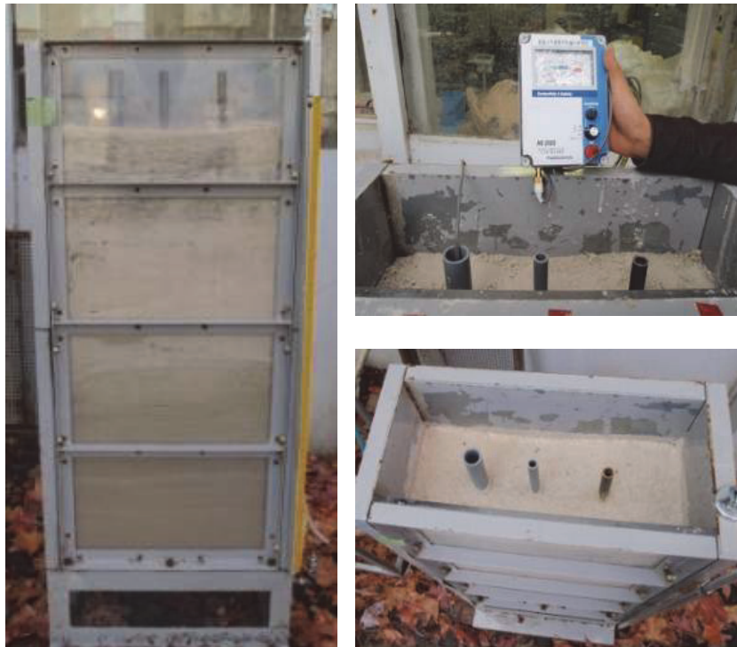
写真 3.2.8 基準水位に用いた観測井戸の実験
