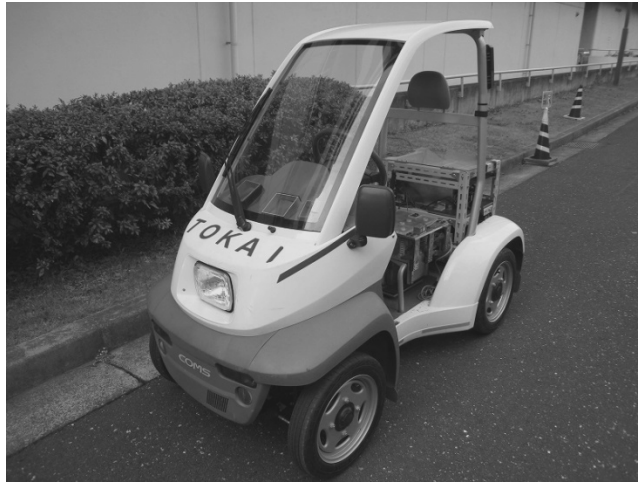
図 2-1 超小型電気自動車（トヨタ車体制エブリデーコムスベーシック）
