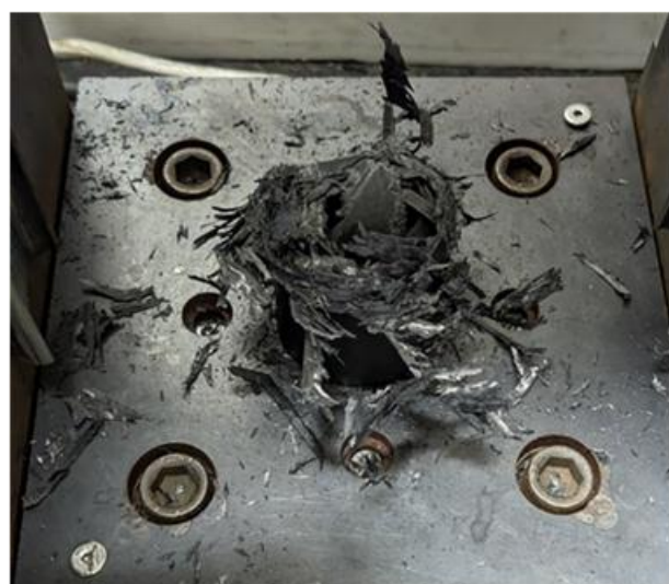
(b) Specimen E [45^\circ/-45^\circ/45^\circ/-45^\circ/45^\circ]
