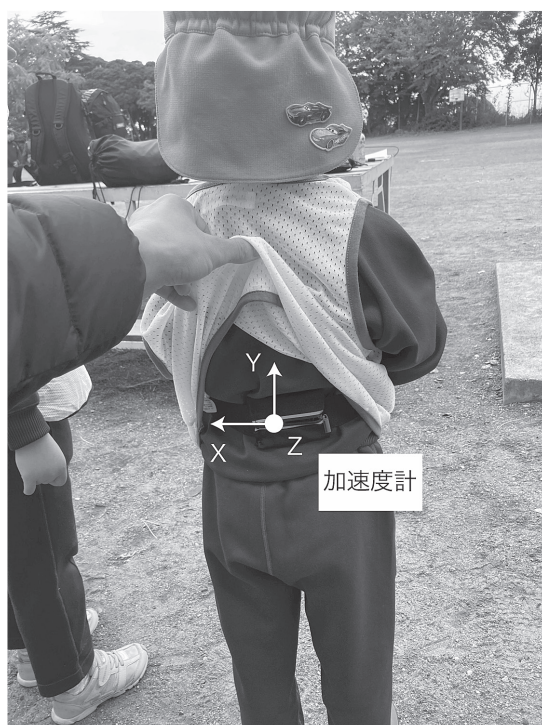
図1 加速度計の装着位置 Fig. 1 Accelerometer mounting position
