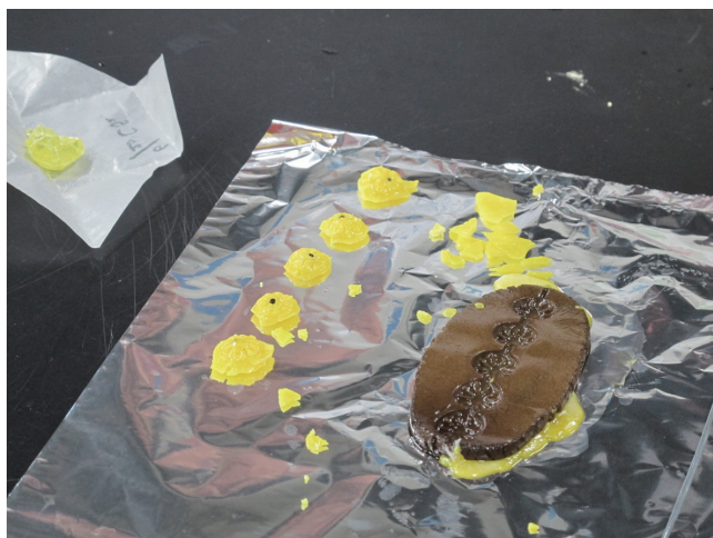
図5 オリーブ油を塗布した土製型（花型）に硫黄を流し込み、硫黄個化後、型から外した（筆者撮影）
