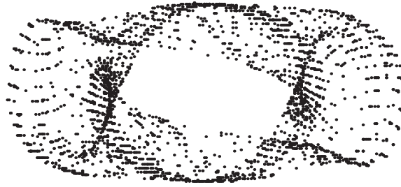
Fig. 4.17: ストレンジアトラクターが見られる位相空間図
